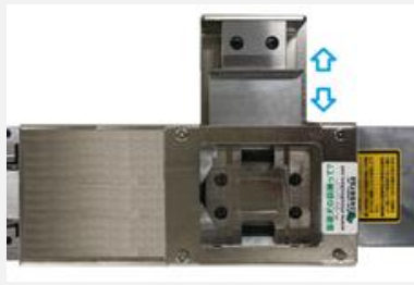
CPUをスムーズにセット・殻割・簡単排出（操作レバーを左右に振る）
