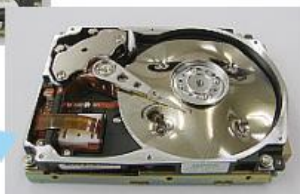
穴あけしたHDD内部の画像
