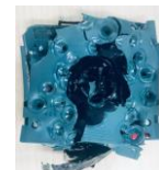
4回移動クラスター破壊 16カ所の孔とねじれ破壊 (30秒)
